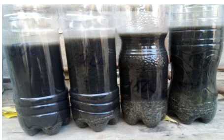
Рис. 2. Состояние осадка после 20 мин.
