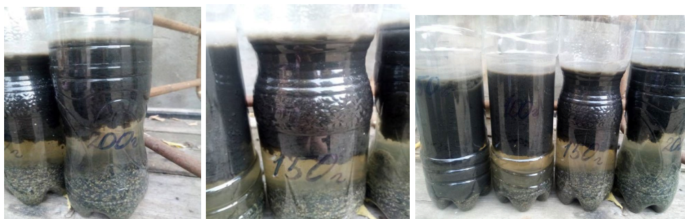
Рис. 5. Состояние осадка после четырехчасового отстаивания
