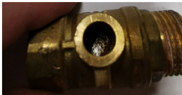
Рис. 6. Место излома штока в корпусе шарового крана № 1
