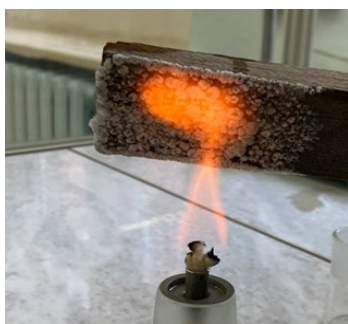
а) При огневом воздействии образуется слой, препятствующий горению древесины
