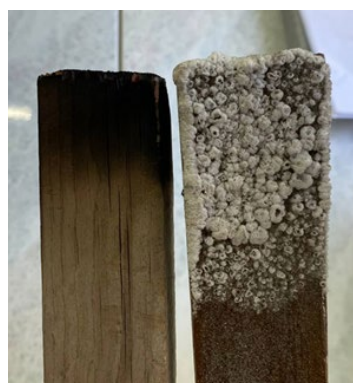
б) Образцы из дерева после воздействия огня
