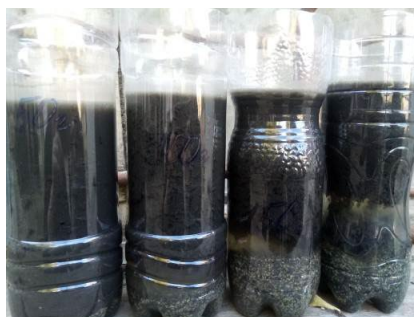
Рис. 3. Состояние осадка после 40 мин.
