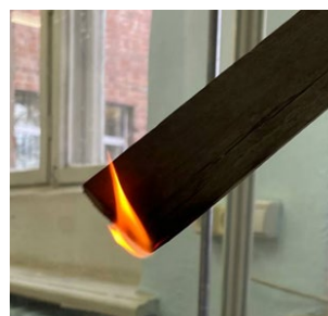
б) Горение незащищенной древесины продолжается и без источника пламени
