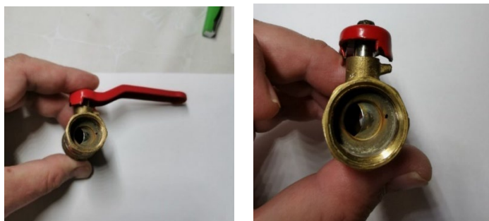
Рис. 4. При повороте ручки рабочий орган не двигается (кран № 1)
