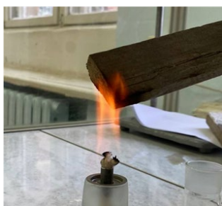
а) Ничем не обработанная древесина воспламеняется в процессе огневого воздействия
