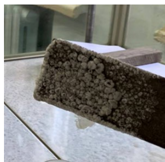
б) Горение прекращается сразу после прекращения огневого воздействия
