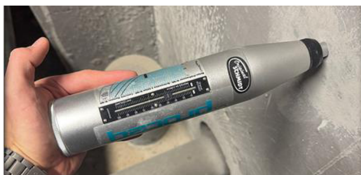
Рис. 2. Измерение прочности бетона молотком Шмидта
