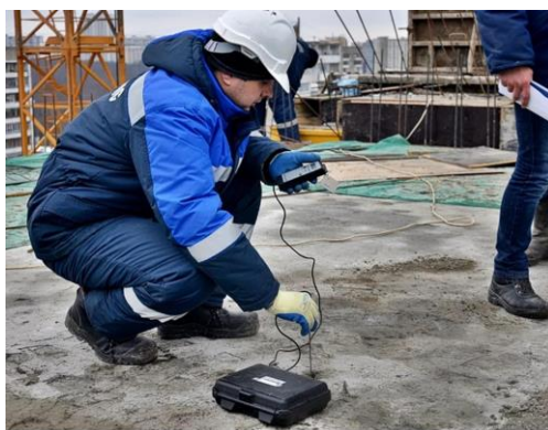
Рис. Процесс определения характеристик сейсмоизолирующего фундамента
