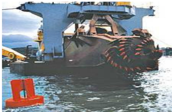
Рис. 14. Многофункциональная баржа с оборудованием для углубления и выравнивания траншеи и земснаряд для разработки твердых пород грунта
