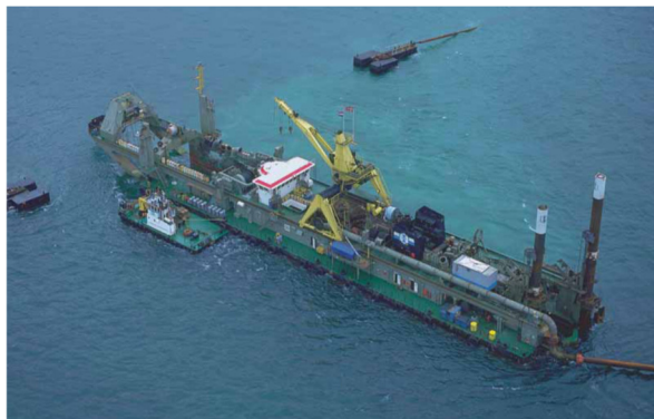
Рис. 14. Многофункциональная баржа с оборудованием для углубления и выравнивания траншеи и земснаряд для разработки твердых пород грунта
