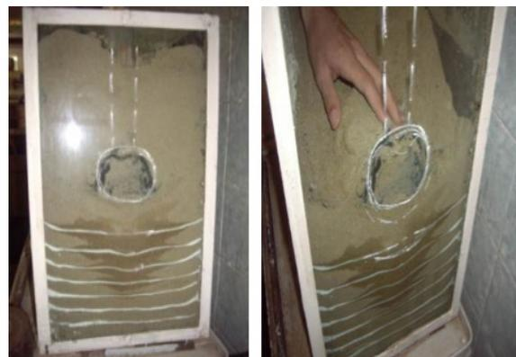
Рис. 4. Свая в грунтовом лотке с красящими изолиниями и концевым сферическим уширением, образованным нагнетанием силиката натрия (Купчикова Н. В., 2014 г. [12])
