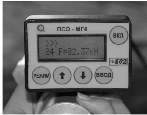
Рис. 2. Адгезионная величина отрыва образца в с. Никольское
