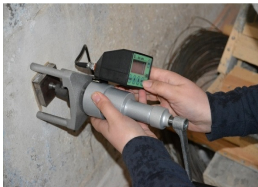
Рис. 1. Процесс отбора образцов штукатурного раствора и измерение силы сцепления его с поверхностью
