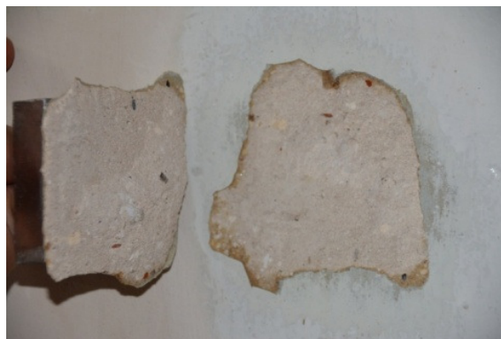
Рис. 1. Процесс отбора образцов штукатурного раствора и измерение силы сцепления его с поверхностью
