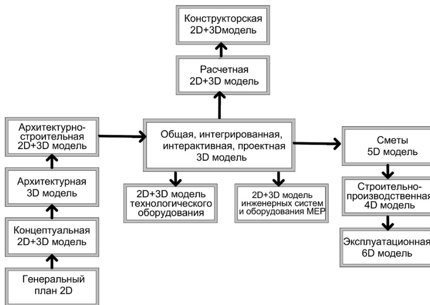
Рис. 1. Схема BIM-проектирования и строительства в России
