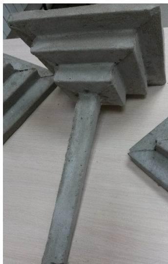
Рис. 8. Модель ступенчатой ж/б сваи размерами 1000×300×300 в верхней части
