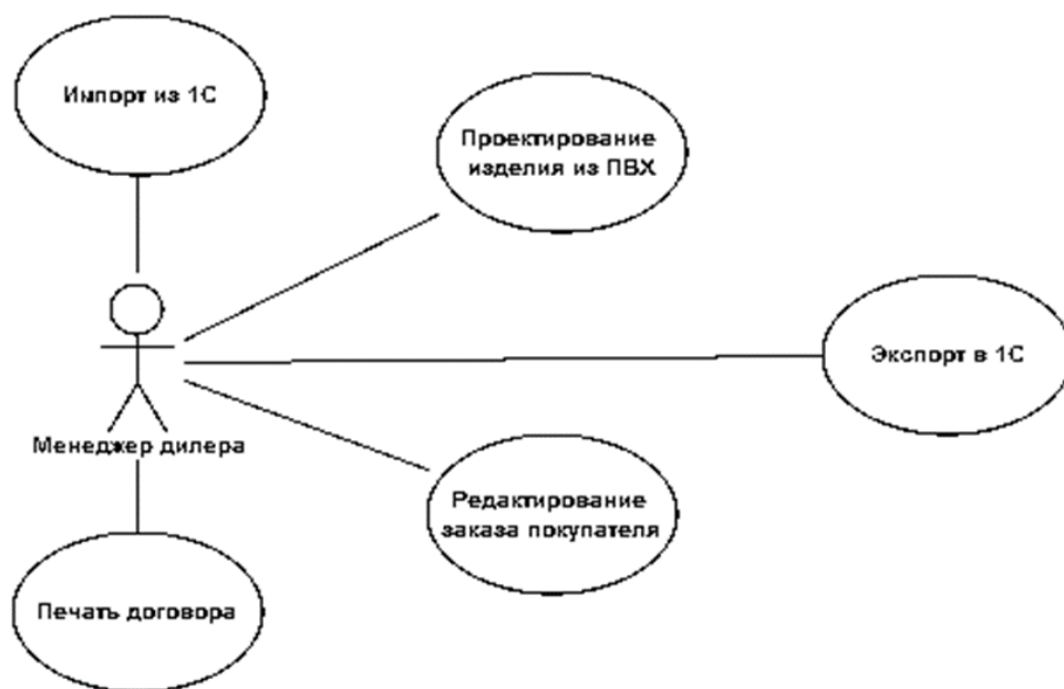
Рис. 1. Диаграмма вариантов использования .NET модуля
