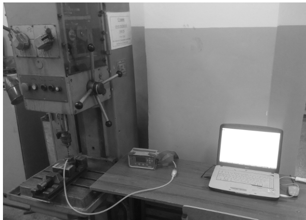
Рис. 3. Экспериментальная установка для проведения исследования зависимости концентрации оксида углерода от подачи и частоты вращения шпинделя
