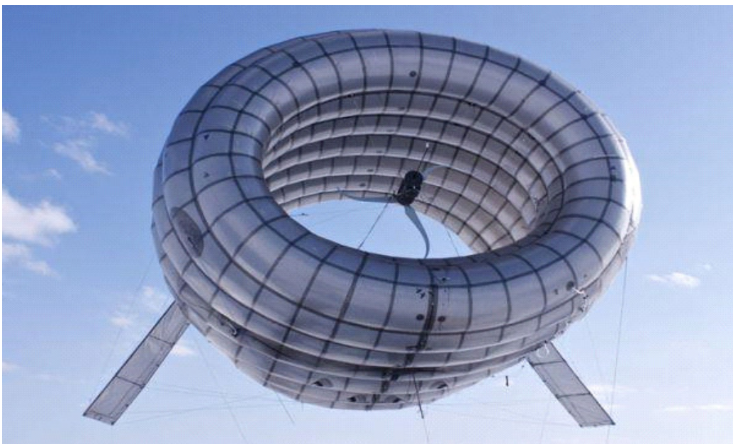
Рис. 2. Аэростат высотной ветроэнергетической установки
