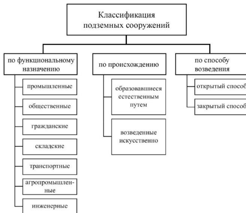
Рис. 3. Классификация подземных сооружений
