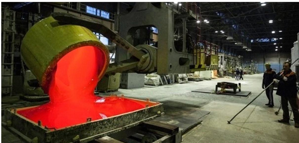
Рис. 4. Вылив ситалла из изложницы при производстве литого изделия
