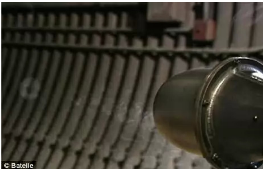
Рис. 1. Коаксиальная пушка стреляет кольцами дыма
