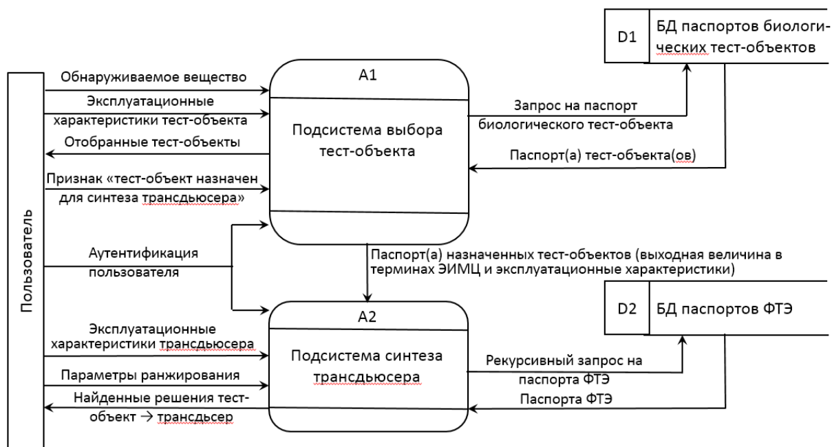
Рис. 2. Диаграмма потоков данных автоматизированной системы (DFD модель данных)
