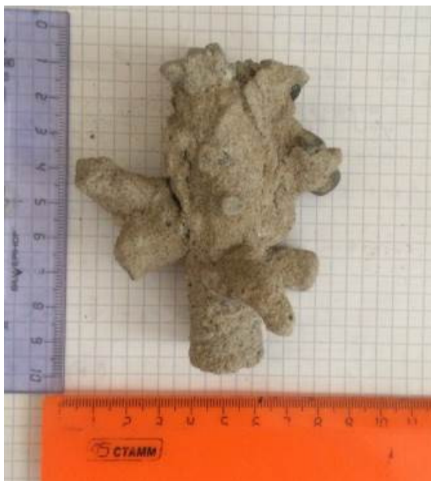
Рис. 3. Грунтобетонный кластер корневидной формы (после отмывки)
