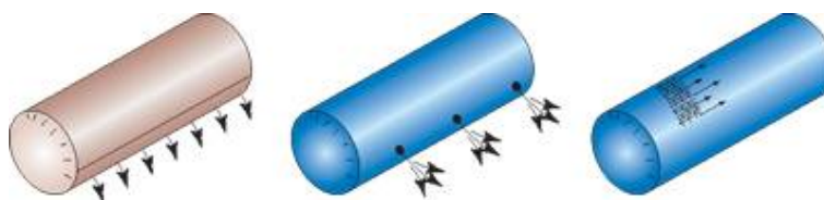
Рис. 1. Принципы подачи воздуха через тканевые воздуховоды:
