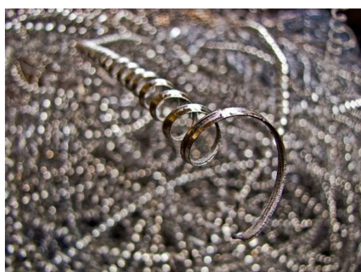
Фот. 3. Сливная (бесконечная) стружка, превращаемая в проволоку
