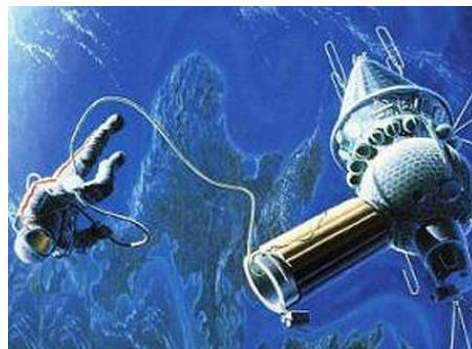
Рис. 1. Надувная секция-шлюз на корабле «Восход 2»
