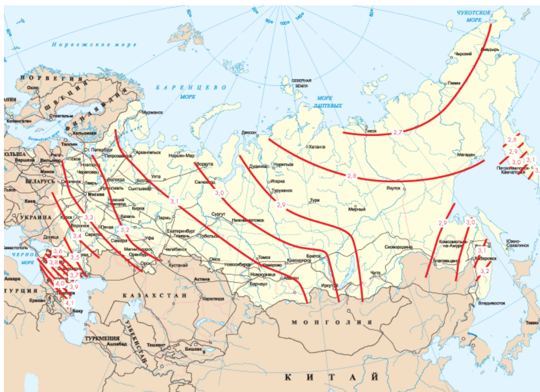
Рис. 1. Эффективные районы территории России низкопотенциальной тепловой энергии поверхностных слоев Земли для систем теплоснабжения и кондиционирования
