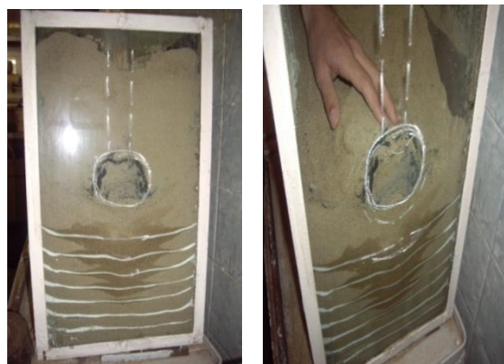
Рис. 9 Конструкции микросвай с втрамбовыванными уширениями из сухой цементно-песчаной смеси (Мальшкин А. П., Есипов А. В., 2002г. [19]): а – конусное уширение, б – сферическое уширение
