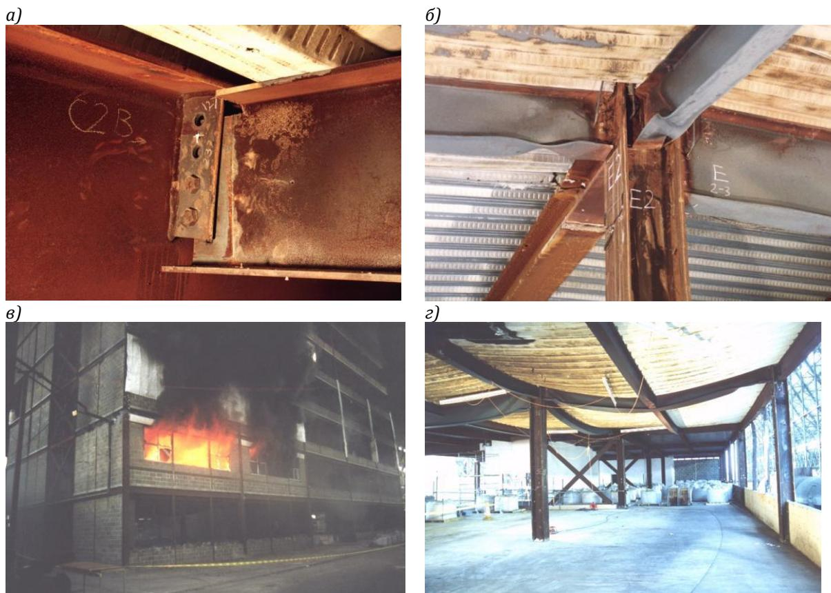
Рис. 2. Испытания стального каркаса в Кардингтоне: а – отказ соединения (тест 2 – испытание плоской рамы); б – потеря местной устойчивости балок (тест 3 – угловое испытание); в – пожар в отсеке (тест 4 – пожар в офисном помещении); г – последствия мембранного эффекта в тесте 4
