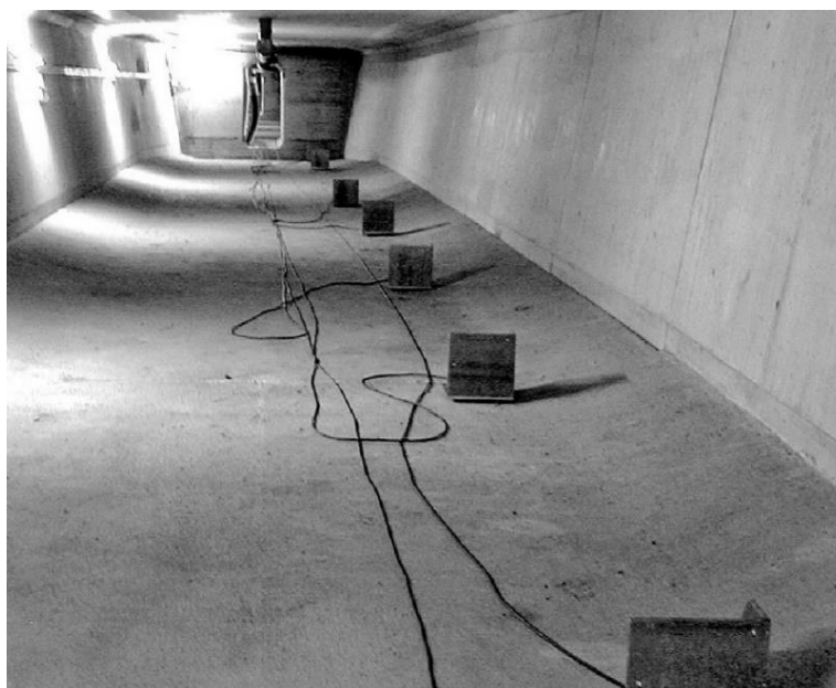
Рис. 4. Система мониторинга технического состояния мостов BRIMOS [21]
