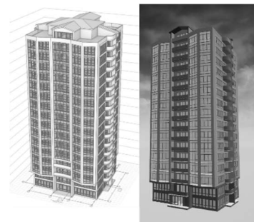
Рис. 4. Сравнение визуализации в Renga (слева) и в модуле интерактивной визуализации (справа)
