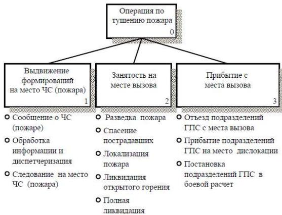
Рис. 7. Диаграмма дерева узлов модели операции тушения пожара
