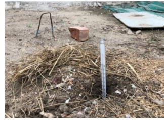
Рис. 7. Измерение температуры почвы при использовании в качестве мульчматериала – соломы
