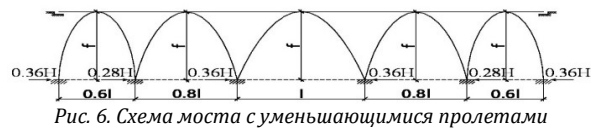
Рис. 6. Схема моста с уменьшающимися пролетами
