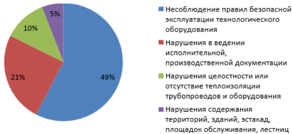
Рис. 3. Анализ нарушений, выявленных в ходе проверок Астраханского газоперерабатывающего завода
