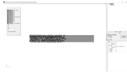
Рис. 2. Визуализация моделирования движения людского потока через проемы различной ширины в программно-вычислительном комплексе Сигма ПБ
