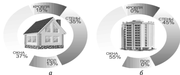
Рис. 1. Основные теплопотери жилых зданий (без учета вентиляции):
