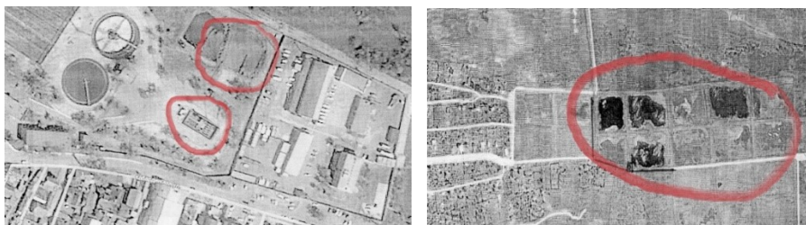
Рис. 4. Приемная камера, песколовки, иловые площадки Южных очистных сооружений канализации (Золотой Затон)
