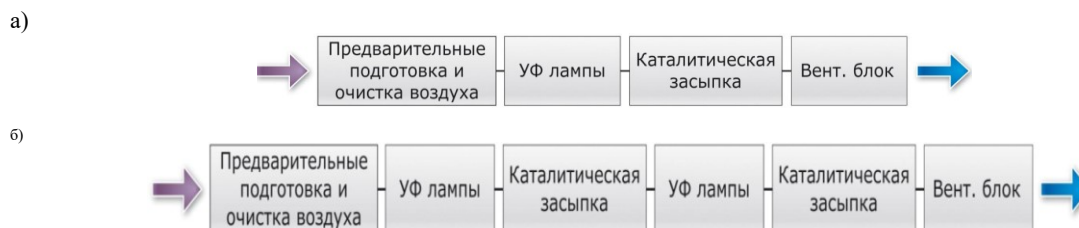
Рис. 6. Схема одностадийного (а) и двухстадийного (б) фотосорбционно-каталитического метода
