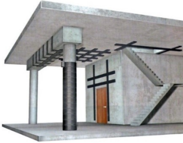
Рис. 3. Места укрепления композитными материалами зданий и сооружений
