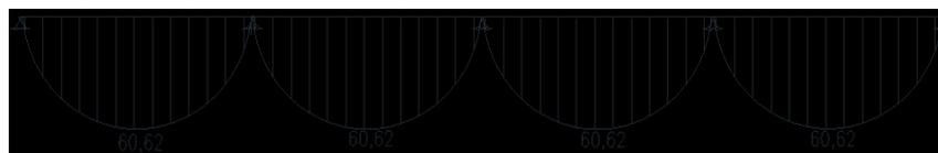
Рис. 3. Эпюра изгибающих моментов шарнирно опертой балки от действия собственного веса
