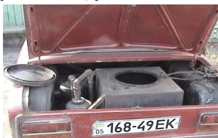
Рис. 2. Газогенератор в багажнике автомобиля
