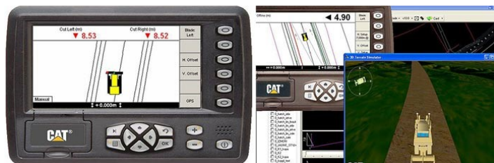
Рис. 1. Система нивелирования для бульдозеров
