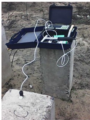
Рис. 5. Прибор ПДС-МГ 4 (предварительные натурные испытания на строительной площадке г. Астрахани)
