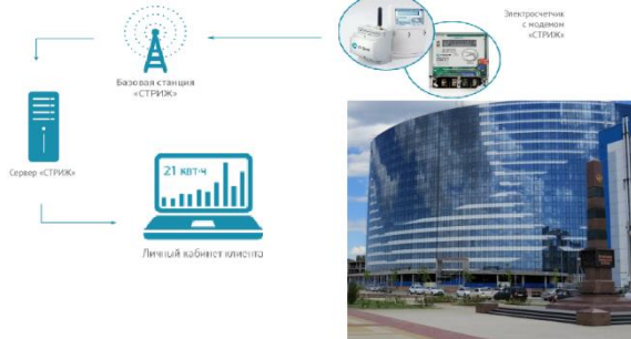
Рис. 1. Учет электроэнергии с помощью АСКУЭ в ЖК «Паруса»
