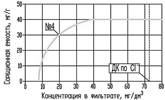
Рис. 10. Зависимость динамической адсорбционной емкости от концентрации активного хлора на модельном растворе № 4 в фильтрате
