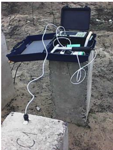
Рис. 8. Прибор ПДС-МГ 4 (предварительные натурные испытания на строительной площадке г. Астрахани)
