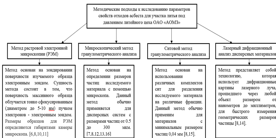
Рис. 3. Основные методические подходы к исследованию параметров свойств отхода асбеста в кусковой форме
