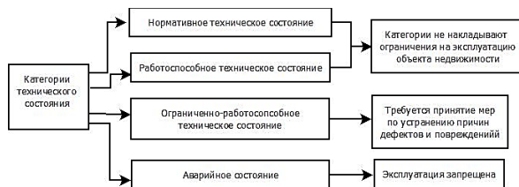
Рис. 3. Категории технического состояния обследуемых объектов
