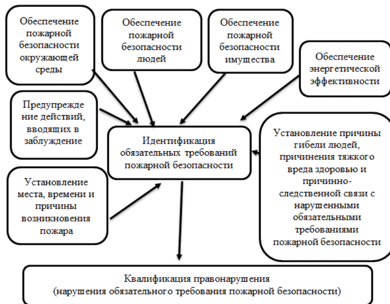
Рис. Информационная модель расследования пожаров с гибелью людей на основе идентификации обязательных требований пожарной безопасности
