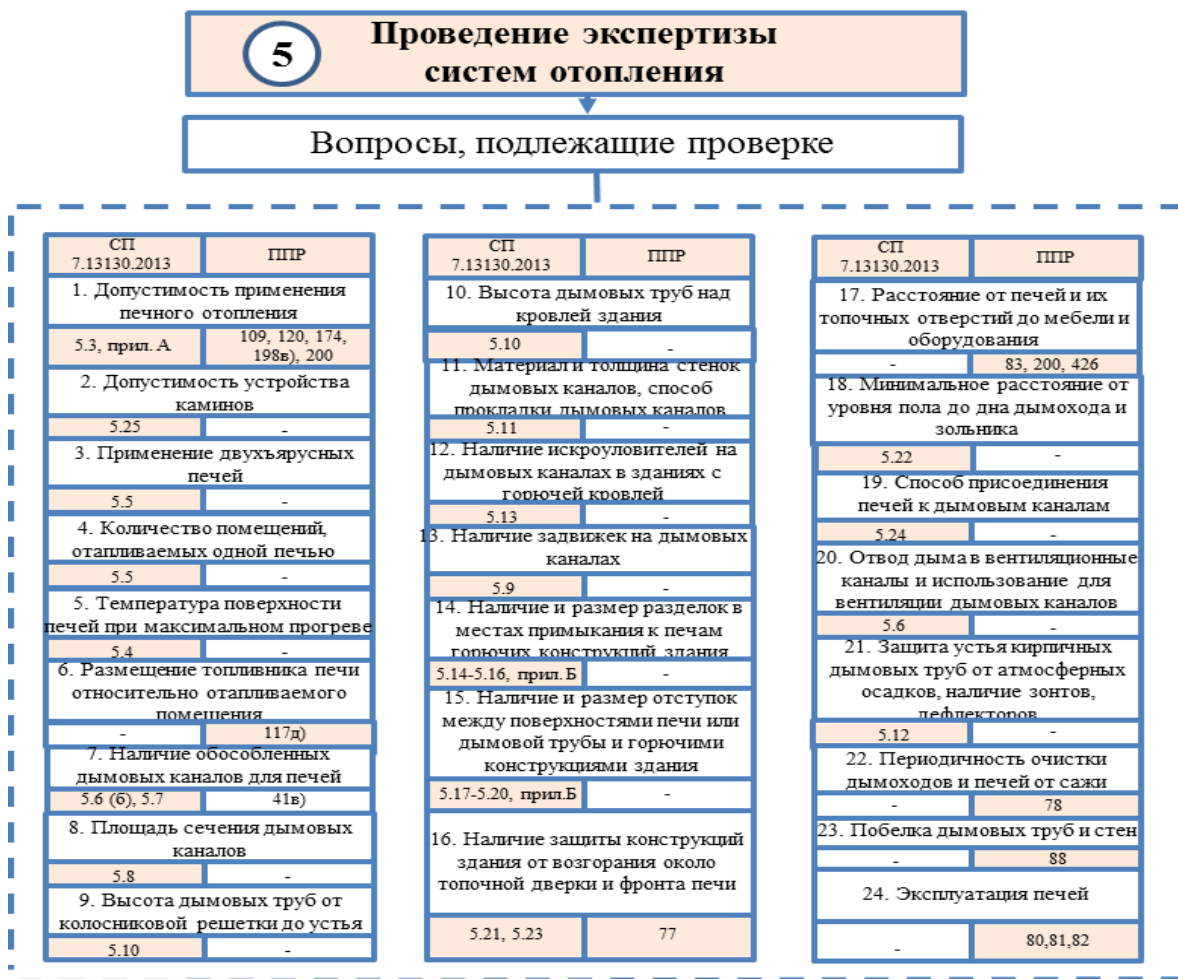
Рис. 6. Структура методики проведения экспертизы систем отопления (пример из исследования)
