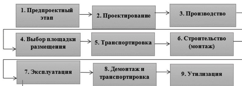
Рис. 1. Жизненный цикл ветроэнергетической установки
