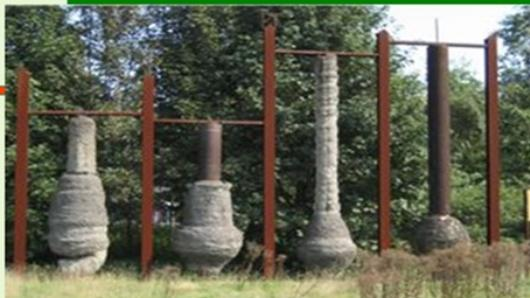
Свая Franki с уширением образованным впрессовыванием бетона цилиндром-поршнем в скважину (1960г.)
