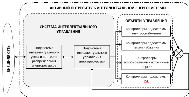
Рис. 2. Обобщенная структурная схема системы автоматизации активного потребителя
