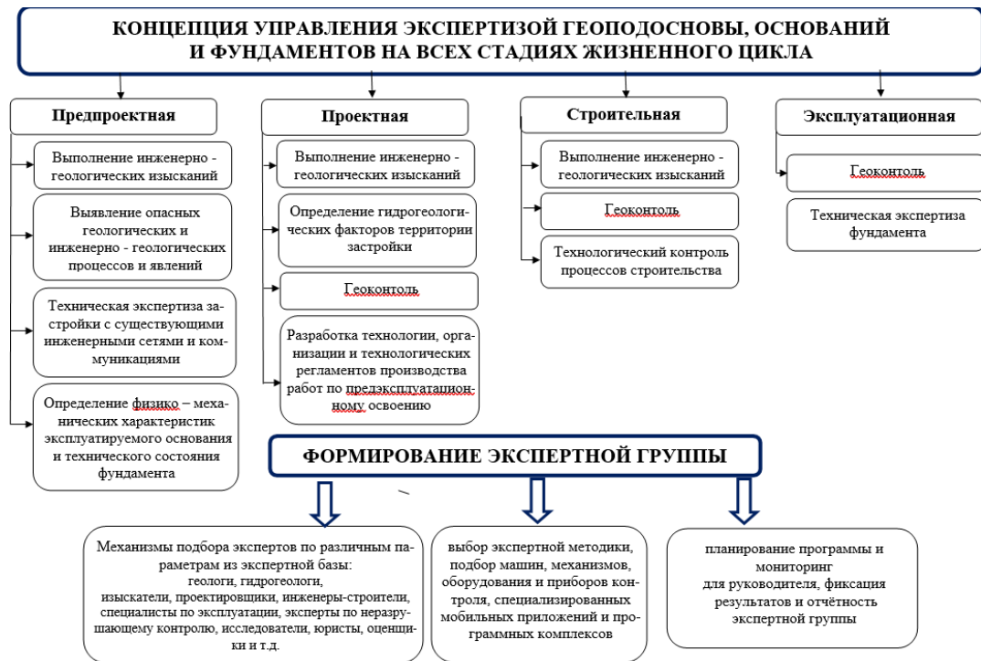
Рис. 5. Схема концепции управления и формирования экспертной группы в экспертизе геоподосновы, оснований и фундаментов
