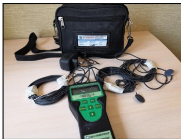
Рис. 4. Прибор ИТП-МГ4.03/Х(III) «Поток»
