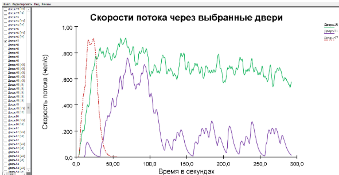
Рис. 6. Скорости потока через выбранные двери
