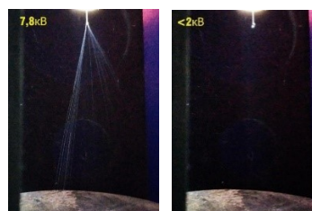
Рис. 6. Фото капель и факела распыла при различном напряжении на электродной системе модернизированного сталагмометра
