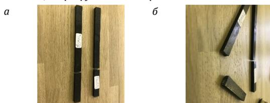
Рис. 7. Разрушенный образец Titan GF12: а, б – разрушение материала вдоль волокон
