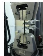
Рис. 3. Образец в разрывной машине Instron 5982
